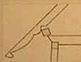
Die unzureichende Queraussteifung der Dachkonstruktion
